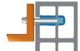
Tvirtinimas kiaurymėtuosiuose blokeliuose
